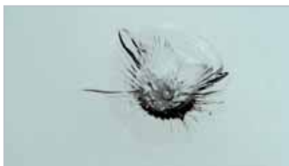
b) Delimična pukotina
